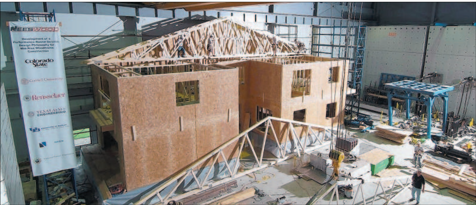
Wird künstlichen Erdbeben unterzogen: zweistöckiges Holzhaus auf Rüttelplatten. Oben der Versuchsaufbau. FOTOS: Doug Levere/University at Buffalo
