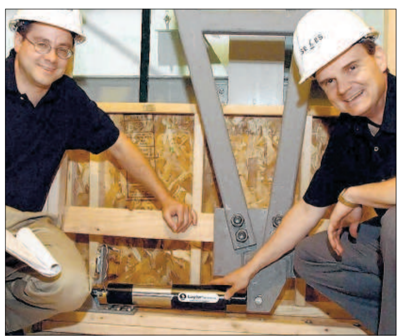
Die Professoren Michael Symans (links) und Andre Filiatrault mit einem Dämpfer. Er hängt unten an einem wandhohen, dreieckigen Metallgerüst, das in Holzwände eingebaut wird. FOTO: Joseph Parisi/University at Buffalo
